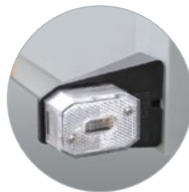
Markeringsverlichting voorzijde vanaf breedte 126 cm
