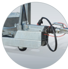
Accessoire; koppelingverhoger van 5 of 10 cm
